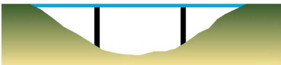
⋮ Pont à poutres
