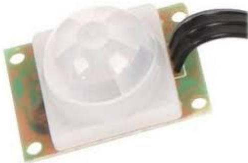
Capteur de présence (alarme de détection)
